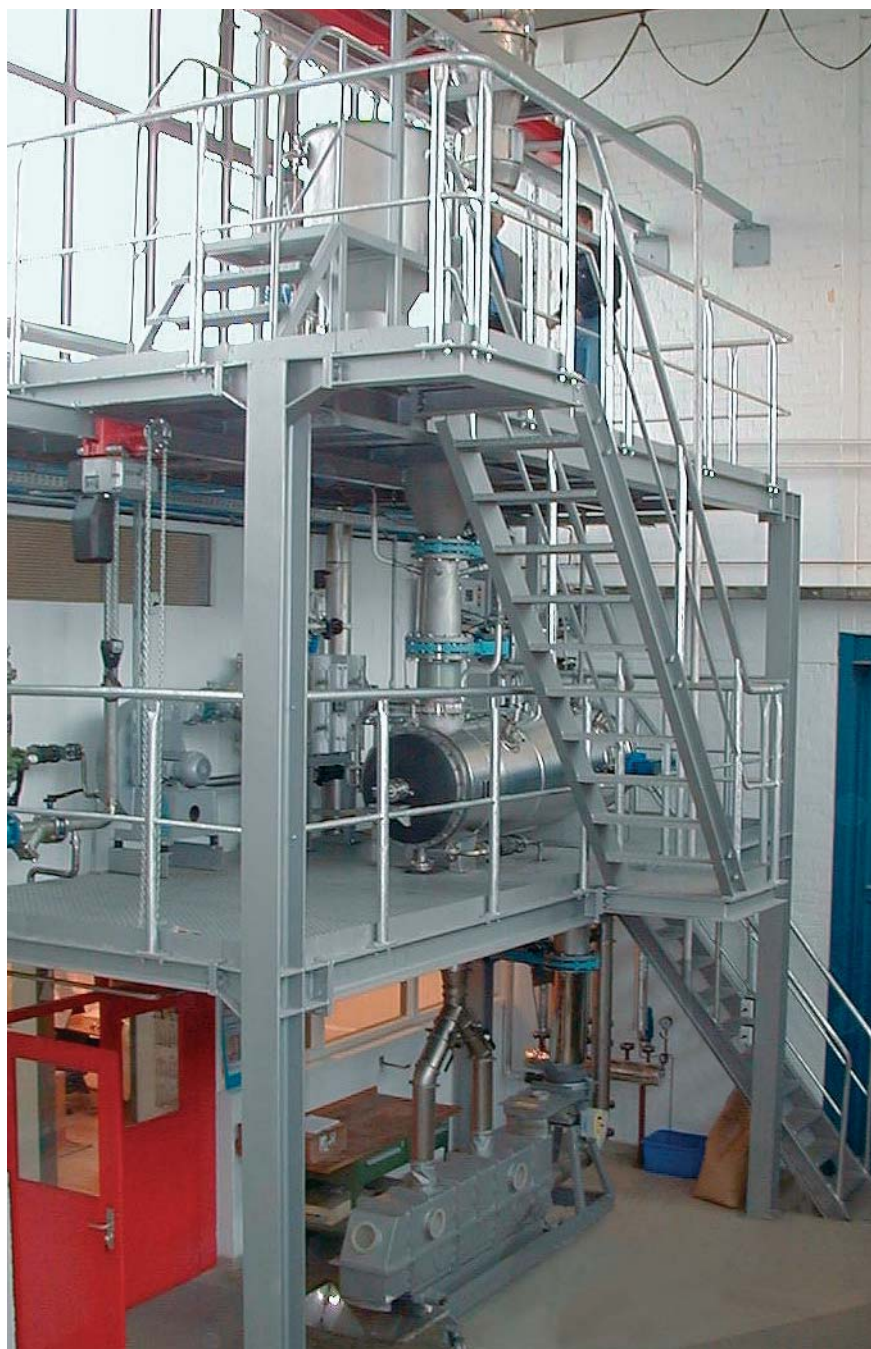
Гидротермическая варочная установка на экспериментальной установке фирмы «SCHULE» в г. Райнбек
