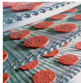
Непрерывная заморозка на спиральных морозилках фирмы «HEINEN»
