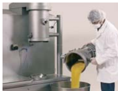
Опытная установка фирмы «HEINEN Drying» по технологии процессов в псевдооживленном слое
