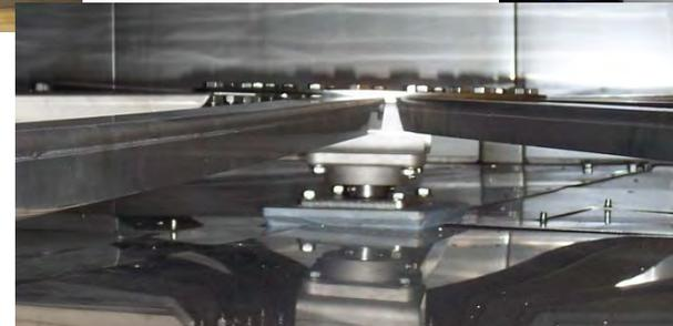
■ устойчивый для вращающейся системы промышленный дизайн, с болтовыми соединениями основных элементов для большей прочности, а также для удобного обслуживания системы
