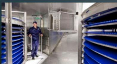
С одной или с двумя башнями в трех возможных диаметрах, с четырьмя возможными вариантами расположения входа конвейерной ленты в систему относительно выхода, с движением ленты вверх или вниз, установленный на полу помещения, на фундаменте или раме – acticool не только легко интегрируется в производственный процесс внутри помещения, но и отвечает всем требованиям по производительности.
