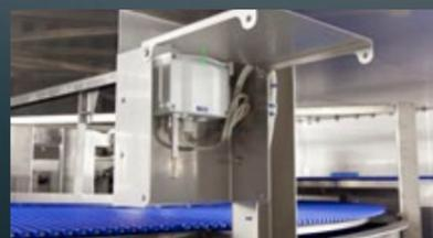
Самая современная автоматика следит за точностью потока прохладного воздуха, мягкостью охлаждения и соответствием фактической температуры продукта на выходе заданной температуре. Многочисленные датчики, частотно-регулируемые вентиляторы, автоматически управляемые воздушные жалюзийные заслонки следят за балансом объемов приточного, отводимого и циркулирующего внутри воздуха.
