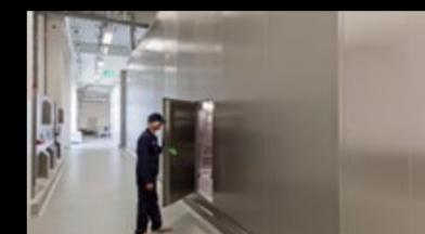
acticool может поставляться с многочисленными опциями, например, в изолирующем корпусе из нержавеющей стали снаружи, с полом, выполненным в виде сварной герметичной ванны с отдельными стоками, с ультразвуковым увлажнением или увлажнением под высоким давлением – в полном соответствии с Вашими пожеланиями.
