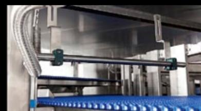
Система очистки конвейерной ленты с насосным блоком для повышения давления воды и пенообразования может быть в любой момент расширена до полностью интегрированной системы, выполняющей очистку не только ленты и конвейерной системы, но и всего внутреннего пространства.
