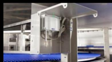
Благодаря непрерывности климатического контроля за процессами осушения, подогрева и увлажнения и очень низкой скорости потока воздуха за счет разделения всего его объема на отдельные потоки, направляемые частотно-регулируемыми вентиляторами, proofline позволяет создать исключительно точные климатические условия для процесса расстойки.
