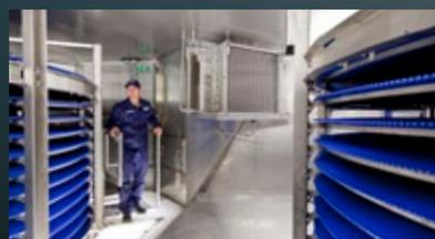
С одной или с двумя башнями в трех возможных диаметрах, с четырьмя возможными вариантами расположения входа конвейерной ленты в систему относительно выхода, с движением ленты вверх или вниз, установленный на полу помещения, на фундаменте или раме – proofline не только легко интегрируется в производственный процесс внутри помещения, но и отвечает всем требованиям по производительности.
