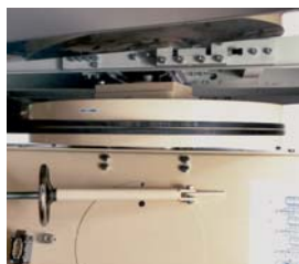
Маховик с 3-х позиционной регулировкой хода
