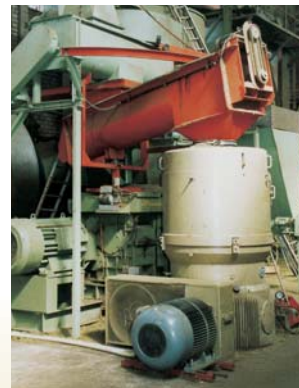
Пресс-гранулятор в составе установки для утилизации отходов
