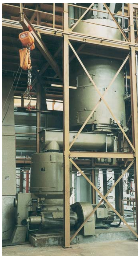
Пресс-гранулятор с биореактором в составе линии по переработке соломы
