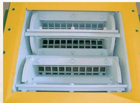
Размер частиц экспандата можно задавать с помощью работающего в одной линии с экспандером измельчительного устройства.
