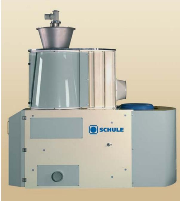
Посредством регулировки шелушильного ротора по высоте можно изменять зазор между абразивными кругами и ситом. Это гарантирует оптимальное приспособление машины к различным размерам продукта, а также оказывать влияние на коэффициент шелушения.
